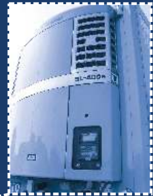
„Kühlaggregat mit computerüberwachter Temperaturaufzeichnung“
