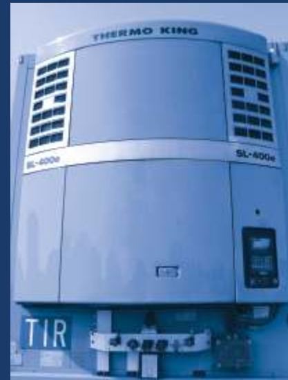
„Kühlaggregat mit computerüberwachter Temperaturaufzeichnung“
